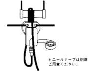
⑤アンテナがねじれないよう注意して設置してください。
